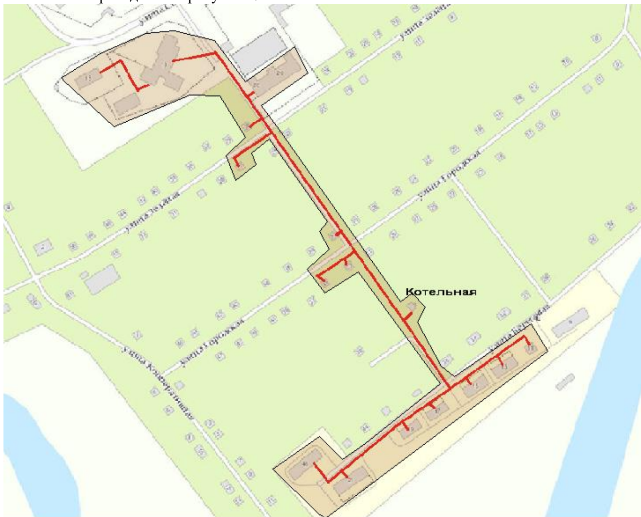
Рисунок 2 – Зона действия источника тепловой энергии
