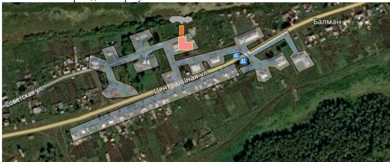
Рисунок 2 – Зона действия источника тепловой энергии
